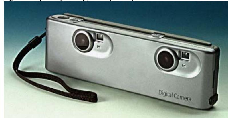
fig. 11 Appareil photo numérique pour photo stéréo
